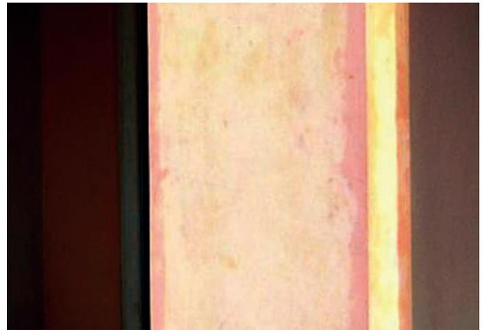
**Atas:** Lapisan cat yang mengalami perubahan warna secara tidak merata.
